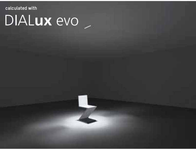
RIDE LENS · 17W · 2700K · 1400lm spot light beam 15^\circ
